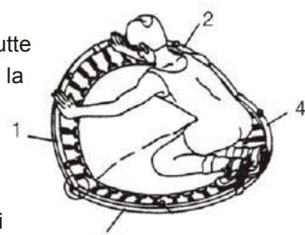
3. Spingere il cuscinetto di sicurezza sul telaio. Assicurarsi che i fori del cuscinetto di sicurezza si trovino esattamente sopra i giunti a vite delle gambe.
