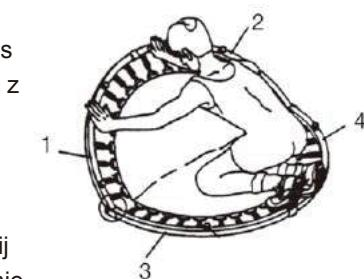
3. Nasuń podkładkę zabezpieczającą na ramę. Upewnij się, że otwory podkładki zabezpieczającej leżą dokładnie nad połączeniami śrubowymi nóg.
