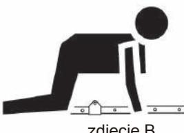
4. Obie osoby klęczą twarzą do górnej połowy składanej trampoliny i kładą kolano najbliżej składanej trampoliny na dolnej połowie ramy, około 2 cala poniżej (nie na zawiasie) (Zdjęcie B).
