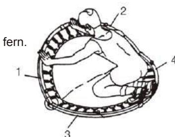
3. Schieben Sie das Schutzkissen über den Rahmen. Stellen Sie sicher, dass die Löcher des Schutzpolsters genau über den Verschraubungen der Beine liegen.
